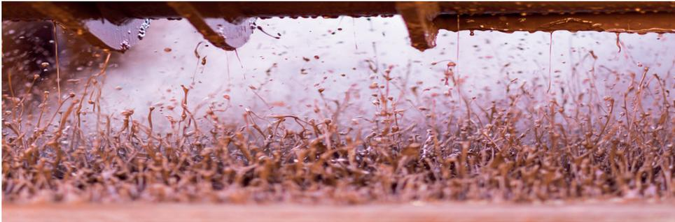
In der Öl- und Gas-Industrie wird Baryt als Gewichtsmittel in Bohr-Flüssigkeiten/-Schlämmen eingesetzt; Foto zeigt diese im "Shale Shaker" eines Bohrergeräts ([Quelle](#))
